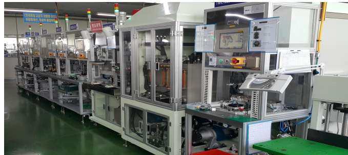
TM Bypass Valve 조립라인
