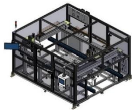
Busbar 자동 체결
